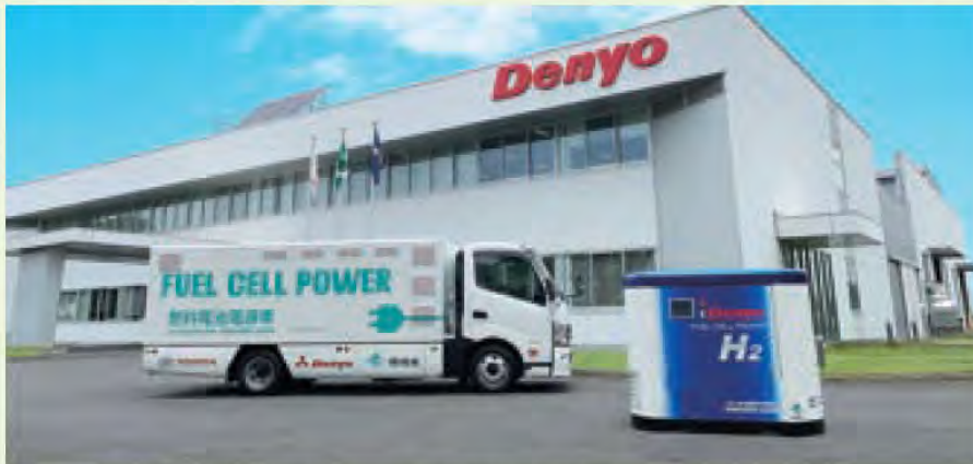
運転中のCO 2 排出量をゼロを実現した燃料電池電源車（左）と燃料電池可搬形発電装置（右）
