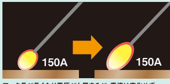
アーク長が長くなり電圧が上昇するが、電流は変化せず。
