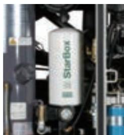
カートリッジ式のエアオイルセパレータを採用し、フィルタレンチでワンタッチ交換できます。
