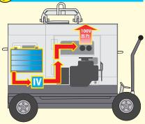
バッテリー充電が完了すると、再びバッテ リー側の出力に切り替え、エンジンを停止 します。
