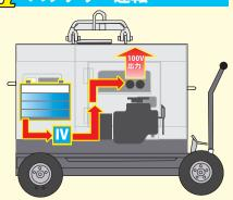
バッテリーから交流 100V に変換し、 交流電源を供給します。
