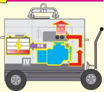
バッテリー残量が少なくなると、自動的に エンジンを始動し、エンジン発電機側から 電源を供給すると同時に、バッテリーの充 電を開始します。
