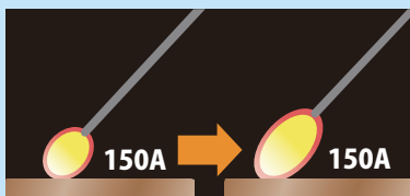
アーク長が長くなり電圧が上昇するが、電流は変化せず
