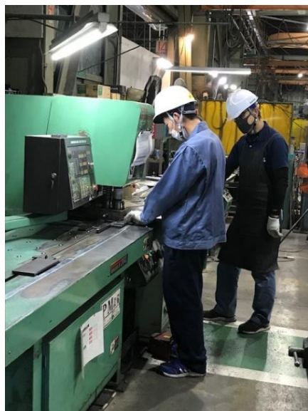
板金工程：切り取り曲げ作業
