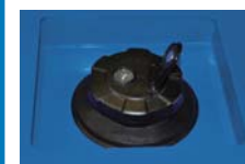
Tapón del tanque de combustible con ranuras
