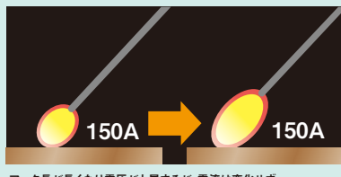
アーク長が長くなり電圧が上昇するが、電流は変化せず
