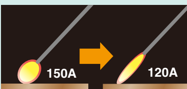
アーク長が長くなり電圧が上昇することで、電流が減少
