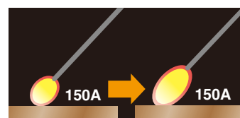
アーク長が長くなり電圧が上昇するが、電流は変化せず
