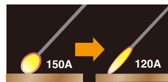
アーク長が長くなり電圧が上昇することで、電流が減少
