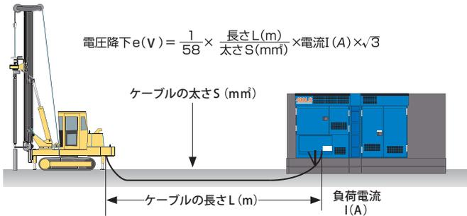
ケーブルに流れる負荷電流が許容電流を超えると過熱により焼損したり、また長さに対して細すぎると電気器具の入力電圧が下がり、仕事量が低下したり、作動しないことがあります。簡略式で求めた電圧降下eが、定格電圧の5%以内になるようにケーブルの長ささと太さを選定してください。
