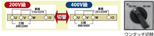
三相出力の電圧を用途に応じて200V級⇔400V級に切替できます。
